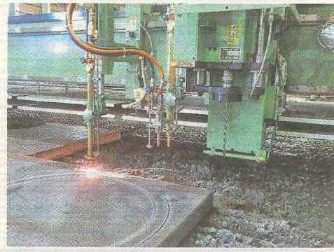
水素切断用NCガス溶断機が並ぶ（手前が新設した「KT-650GD」）①、先穴あけ用ドリル装置付き（写真右）
