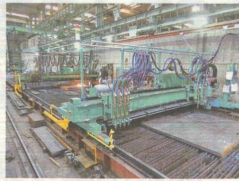
水素切断用NCガス溶断機が並ぶ（手前が新設した「KT-650GD」）①、先穴あけ用ドリル装置付き（写真右）
